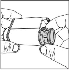
Extraer del agua el filtro de agua INTENZA+ y ajustarlo de acuerdo con la dureza del agua medida (consultar el capítulo «Medición de la dureza del agua») y las referencias presentes en la base del filtro:
